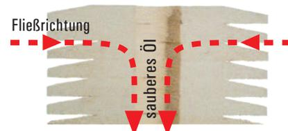
Querschnitt einer CJC™ Tiefenfilterpatrone
